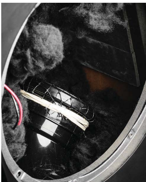
Port bas-refleksu ma znaczną średnicę i jest na tyle długi, że trzeba go było zakrzywić. W tle widoczny panel bitumiczny na tylnej ścianie.
